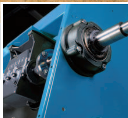
Новая разработка: грязеустойчивая подшипниковая опора с закрепительной втулкой для работы с высокой частотой вращения и сильной ударной нагрузкой
